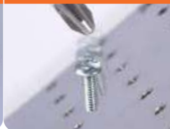
ねじの転倒／横締め／斜め締め
