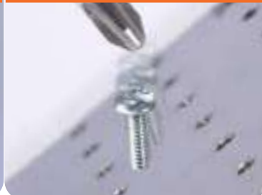
ねじの転倒／横締め／斜め締め
