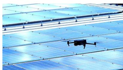
ドローン活用により省人化、効率化が期待される太陽光パネル、外壁、橋梁、狭小空間などの点検およびバルコニーを用いたドローン配達等についての実験を実稼働の物流施設を活用して実施可能。
