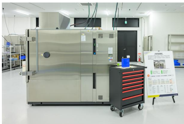
リチウムイオン電池の性能を評価する充放電試験室
