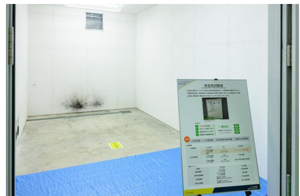
発火試験などを行う安全性試験ブース
