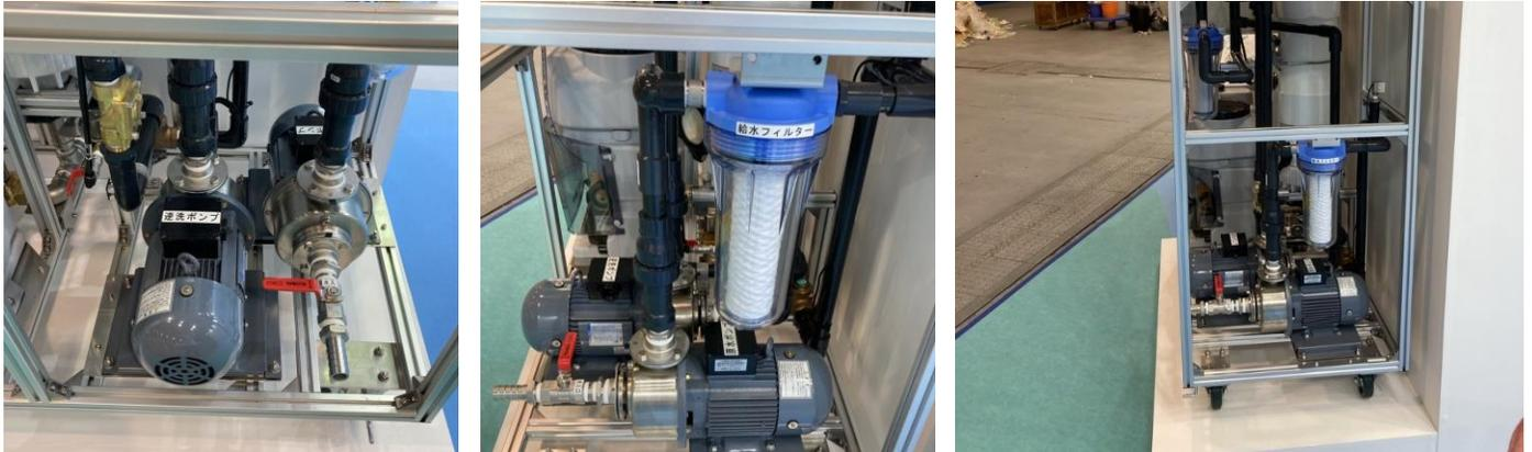
「マクセス・セイフティ」は、水道機工が独自開発した非常災害用造水装置です。河川水やプールの水から一般細菌や大腸菌を除去し、飲用水・生活用水として安全に使用いただけます。また、連続1週間の自動運転、1時間最大2トンの水をろ過可能なため、非常時の生活者の生活を支えます。さらに、誰でも簡単に運転可能。家庭用コンセントまたは発電機（AC100V）に接続し、スイッチを入れるだけで運転操作できます。
