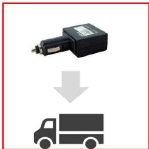
専用端末をシガーソケットに取り付け
