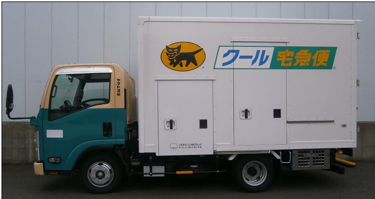
新型車両（従来のように車両前方に冷凍コンプレッサー等を搭載していません）
