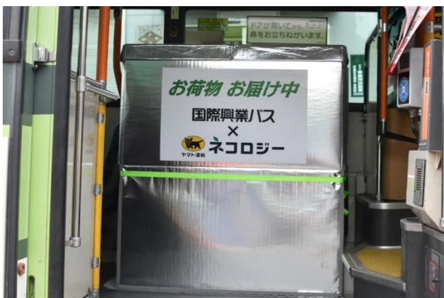
オリジナルクールボックス (縦 600mm×横 1100mm×高さ 1200 mm)
