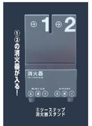
消火に伴う損害を最小限にする消火器スタンド。まずは消火汚損が少ない強化液、次の手段として粉末と、消火薬剤の異なる消火器を段階的に使うことで、被害を最小限に抑えます。パニック時でも、消火被害を抑えるステップが直感的にわかるよう、大きく数字を記載したデザインの消火器スタンドで 2020 年にグッドデザイン賞を受賞しております。
