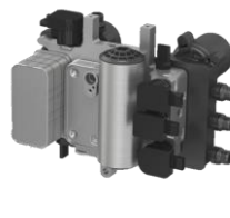
Thermal Management Module: 関連部品をコンパクトに統合。配管をなくし熱ロスや漏れを抑えました。
