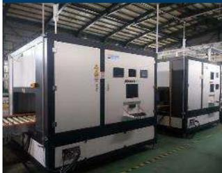
4000Wレーザー溶接装置
