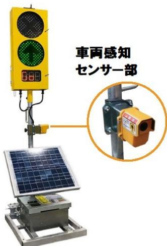
車両感知センサー(超音波)を搭載し、時間帯や曜日によって変化する交通量を常時計測、その結果に基づいて、赤・青・待ち時間を随時コントロールします。交通量の少ない信号機側の青時間を交通量の多い信号機側に移動して青時間を自動的に延長。交通量の多い信号機側の車両を多く流すことで渋滞が緩和されます。
