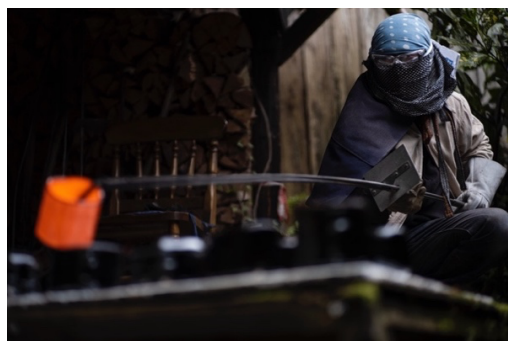
1200 度の窯からの引き出し
