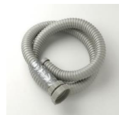
ジャバラホースの割れ補修
