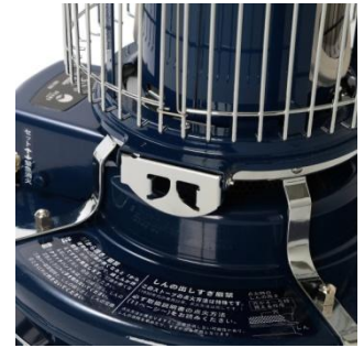
<上枠クリップ> クリップを外し、本体上部を倒すと燃焼部があります。
