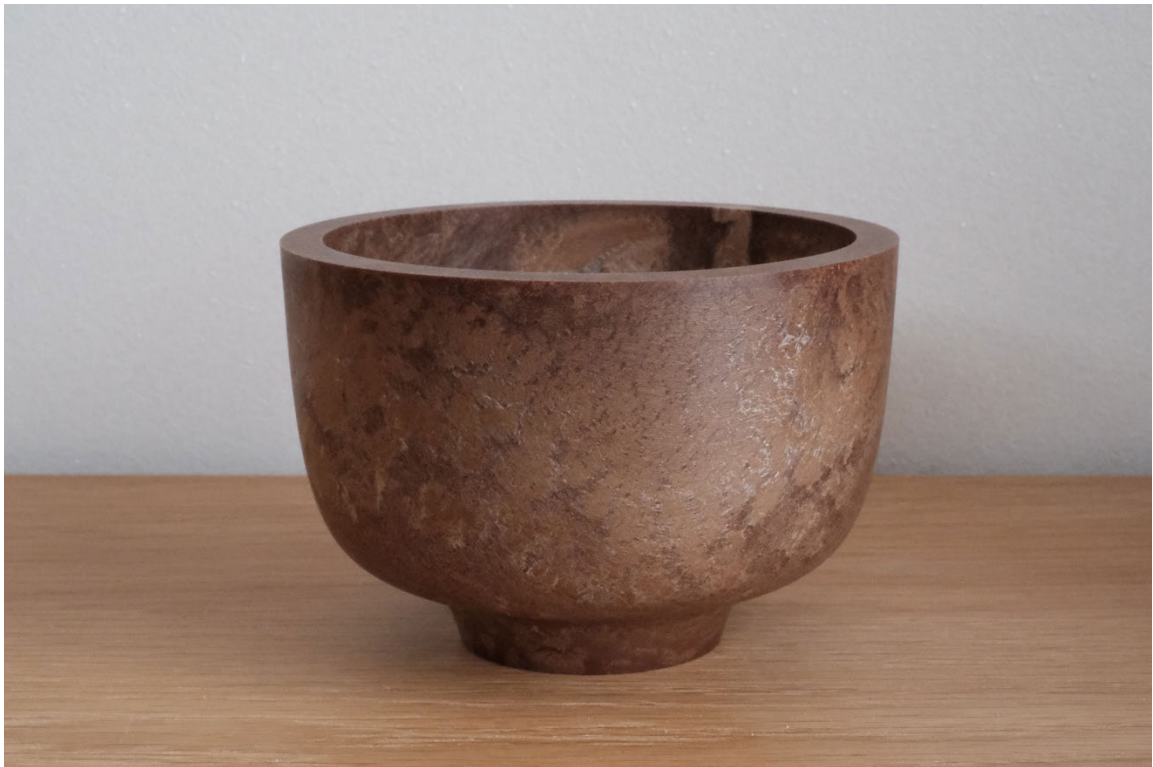
完成した成形木地 山中漆器の櫨の廃木粉をアップサイクルしてバイオマス成形材を開発
