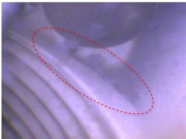
右：機器配管内部の汚れ 赤破線内がバイオフィルム
