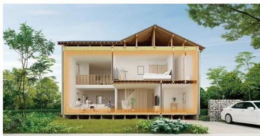
まるごと断熱リフォームは、今ある住まいを、一棟まるごと断熱改修することで高性能住宅化できる先進の工法。すぐれた性能の断熱材により、壁・天井・床をしっかりと覆い、高断熱の窓や玄関ドアに交換。外気温の影響が少なく、快適・健康・省エネを実感できる暮らしを実現。
