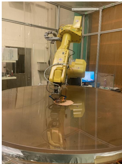
ロジストラボのロボット研磨機による望遠鏡用大型鏡の研磨加工 （提供：株式会社ロジストラボ）
