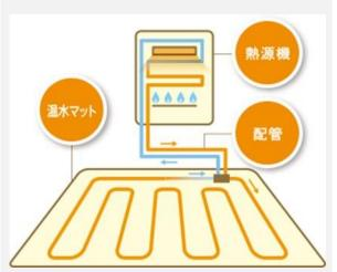
温水式床暖房とは、熱源機で加熱した暖房用の温水を、暖房用のポンプでお部屋に設置した床暖房に循環させ、その熱を利用して暖房するしくみです。
