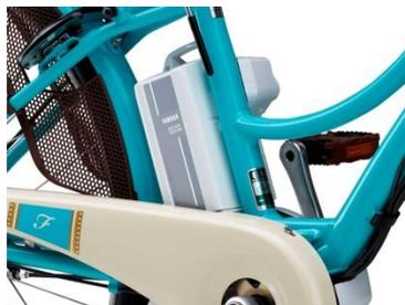
中・長距離の通学にも対応する12.3Ah リチウムイオンバッテリー
