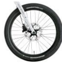
クッション性とグリップ力を兼ね備えた 20"×1.95"の小径タイヤを採用。
