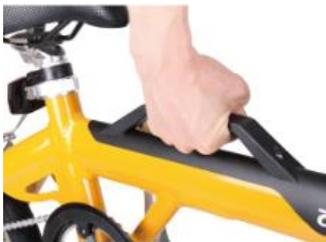
樹脂製の持ち手は、車体の中心を捉えており、自転車を片手で安定して持ち運べます。
