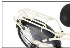
デザインと積載量のどちらも考慮してパイプキャリアを標準で装備。(最大積載量 27kg)
