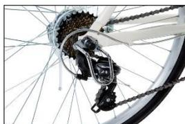
外装7段変速を搭載、変速機、グリップシフトレバー、スプロケット(ギヤ)に至るまで、全て安心のシマノ製。
