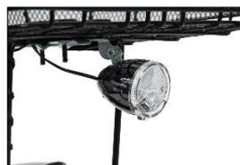
暗くなったら自動で点灯する砲弾型パナソニック製 LED オートライトです。(変速無し、内装 3 段変速どちらにも標準で装備。)
