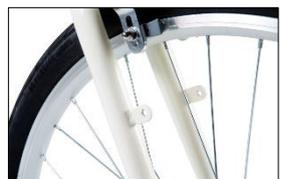
フロントフォークは振動吸収性と耐久性を考慮してスチール製フロントフォークを採用しています。ダボ穴を設置しているので専用のフロントバスケットの取付けなどお好みに合わせて活用できます。
