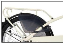
後の子供同乗器を取り付けた際に、子供の足が車輪に巻き込まないように、車輪巻き込み防止カバーを装着。
