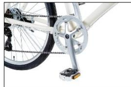
スポーティーでルックスの良いデザインのクランクセット。ガード付チェーンリングで裾の巻き込みを防ぎ、普段着でも足元を気にせずに乗車できます。
