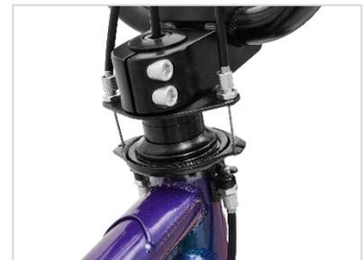
バースピンなど、多彩な回転技を可能にするジャイロブレーキを採用しています。
