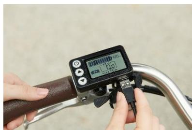
操作が簡単な液晶スイッチパネル。「電池残量」「走行モード」「残り走行可能距離」が一目でわかります。USBポートから、ライトや携帯電話への充電も可能です。
