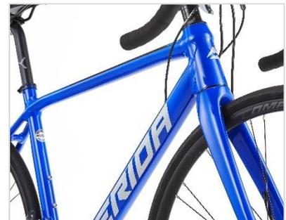
トリプルバテッドアルミニウムを油圧成形した SCULTURA lite-BSA disc フレーム。軽量性、剛性、エアロダイナミクスを兼ね備え、ケーブル類をフレームに内装したことで美しい外観と仕上がりが
