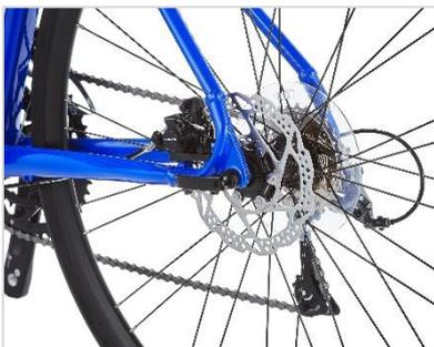
エントリーライダーにも扱いやすいコントロール性と、雨天時でも安定した制動性能をもつ、シマノ製メカニカルディスクブレーキを採用
