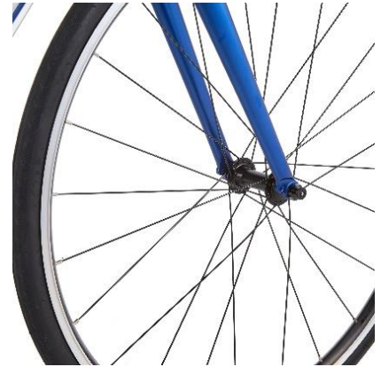
強度を確保しながらも軽量なクロス組車輪
