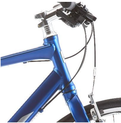
ヘッドチューブを長めに設計し、前傾姿勢を軽減して快適な乗車姿勢を確保
