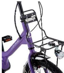
フロントキャリアにはオプションのバスケットを取り付け可能。周囲の暗さを感知し自動で点灯する LED ライトを装備しています。
