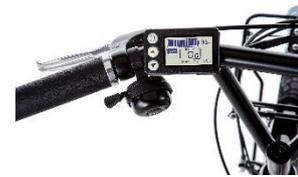
「バッテリー残量」「アシストモード」「スピードメーター」「残り走行可能距離」が一目で見やすい液晶スイッチパネル。USB ポート（1A）を設け、ライトや携帯電話などへの充電が可能です。
