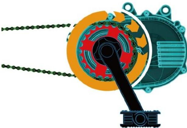
「PLUS-D」にはクランク軸の回転をモーターが直接アシストする最新のダイレクトドライブ方式を採用しており、パワフルでスムーズな乗り心地を提供します。
