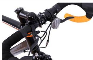
ビギナーが感じるストレスの一つである、ロードバイク特有のドロップハンドルをより扱いやすくするために、通常の自転車ハンドルの握り方でもブレーキをかけられる補助ブレーキレバーを装備。
