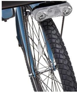
安定感のある太いタイヤで、ちょっとした段差も気にせず走行できます。耐摩耗タイヤを採用しているため耐久性にも優れています。
