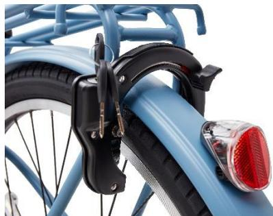
鍵をキャリア後部に取り付け、差込口を上向きに設けることで、狭い場所でも施錠・開錠操作がしやすいよう設計しています。操作性を高めることで、無施錠での盗難リスクを軽減します。
