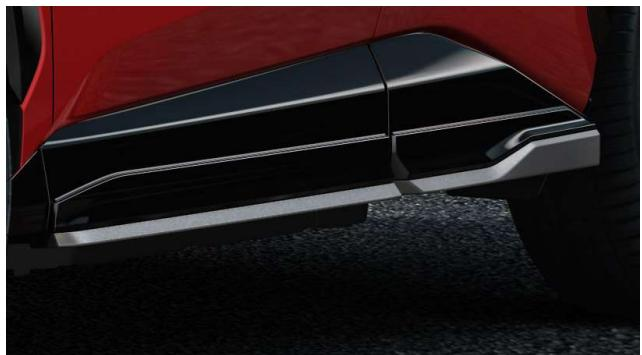
ガンメタリック部の造形を車両ワイド方向に張り出させることで、ロール抑制の効果を狙うと共に、後方のウイングレット形状は、リヤタイヤへの乱流抑制効果を高めます。
