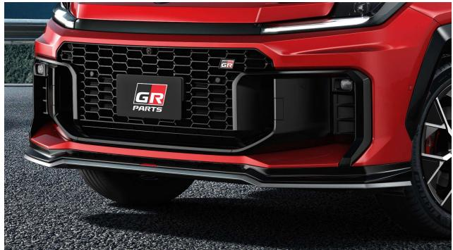
ワイド方向に上向き形状を通し、ダウンフォースの増加を狙いながらフロントタイヤをできるだけ隠す形状にすることで、乱流の抑制効果を高めます。
