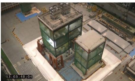
病院建物に地震動を加える実験の映像を会場にて放映します。(国立研究開発法人防災科学技術研究所 兵庫耐震工学研究所「E-ディフェンス」が令和2年12月に実施)
