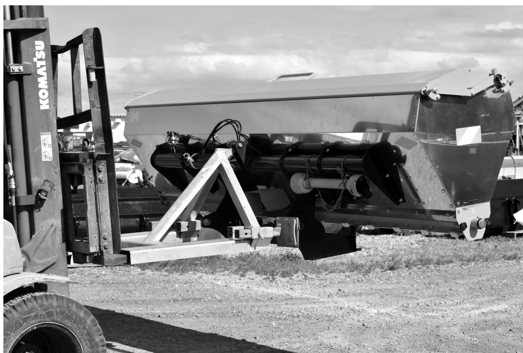
フォークリフトに装着し、農作業機を吊り上げた使用例
