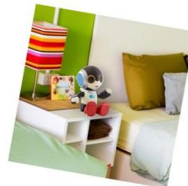
「マイルームロビ」の特徴は、シリーズ初となる5つのセンサー(TV リモコンセンサー、気温・湿度センサー、人感センサー、照度センサー、おでこセンサー)を搭載し、お部屋の環境を認識しておしゃべりしてくれることです。
