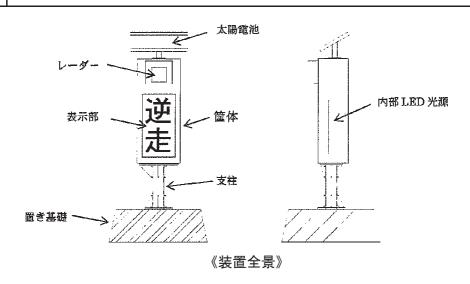
• 逆走車両をレーダーにて検知し、検知信号を受けて一定時間表示部が点滅し、 注意喚起を行うもの。
