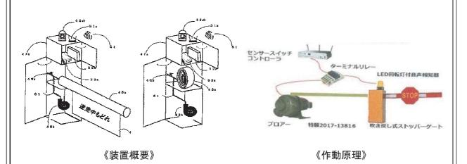
• センサーにより逆走車両を感知するとブロアーにより、膨張式の停止バーが展開し、 遮断機として機能する。
