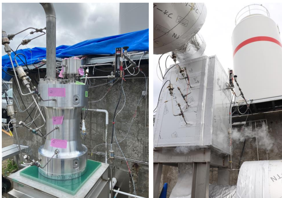
【㊤水素航空機向け液化水素ポンプの 2 次試作 ㊦実液試験終了後の試験設備】
