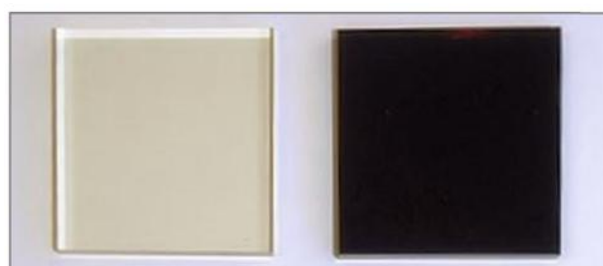
放射線照射後の着色状態比較 (左)耐放射線光学ガラス (右)一般光学ガラス
