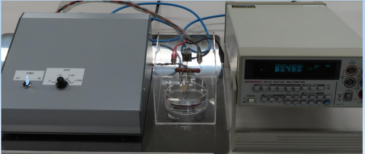
装置全景 (ボルテージフォロワ, 発電素子, 電圧測定装置)
