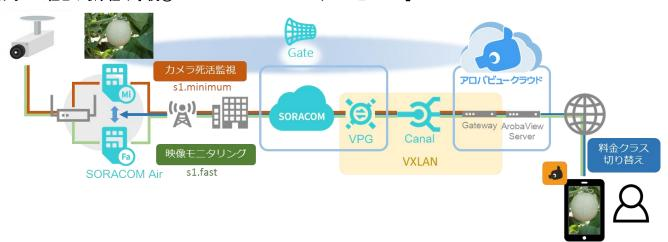
スマートフォンを使って農園の果物の栽培、収穫、出荷指示をしたいというニーズがありましたが、インターネット回線工事が困難なロケーションだったことと、映像ストリーミングに必要な帯域を常時確保すると、通信費用が高くなることが課題でした。SORACOM Air に加え、SORACOM Gate を組み合わせることで、セキュアなモバイル通信ネットワークを介したカメラのリモート操作、およびメンテナンスも実現しました。
