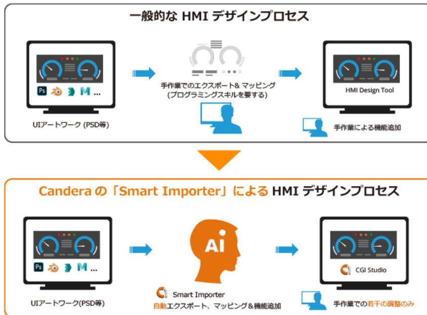
「Smart Importer」は、静的なグラフィックファイルを、フル機能を備えた HMI に自動変換します。
