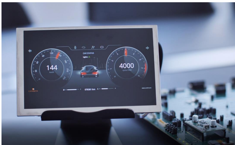
Cypress 社の Traveo II で動作する CGI Studio で作成されたデジタルメータークラスター
