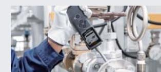
蒸気・エア等の気体配管に取付けられたバルブの内部リークの有無を自動で簡易判定
