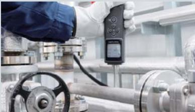
接触式センサーで、測定対象の表面温度を高精度に測定
