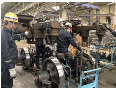
台車の組立作業
