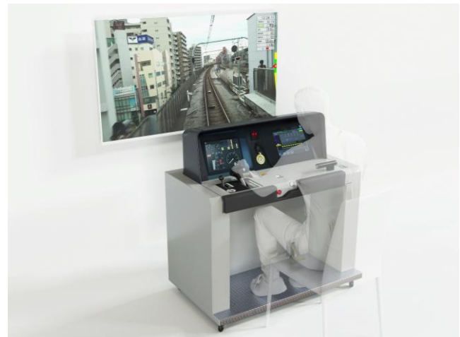
マスコンユニット使用によるシミュレータ運転イメージ
