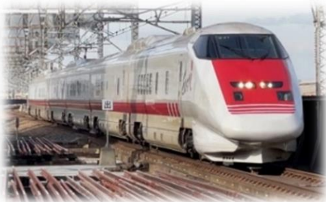
現行の電気・軌道総合検測車 East-i（E926形）
