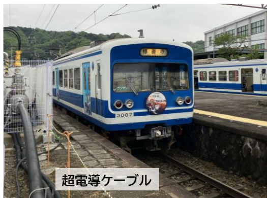
図 1 超電導による電力供給区間を走行する電車（駿豆線での長期運用）
