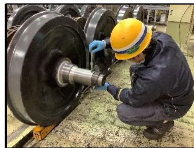
輪軸の検査作業
