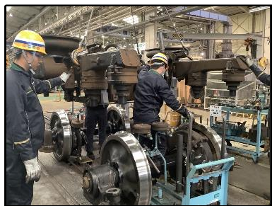
台車の組立作業
