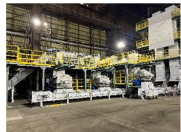
減容機 (破碎、異物除去したプラスチック を圧縮・固化する機械)
