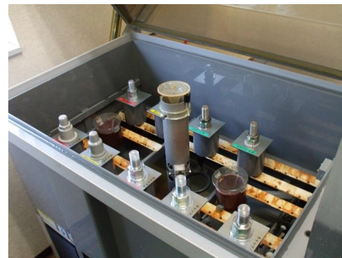
試験片設置状況
